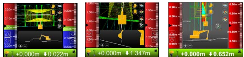
法面施工、平面、横断表示
